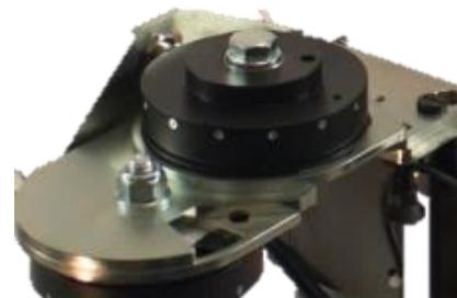
Platine barillet d'électrodes 13, 16 ou 20 mm
